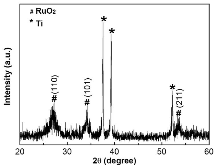
fig. S5. XRD pattern of the  $\text{RuO}_2 \cdot x\text{H}_2\text{O}$ .
